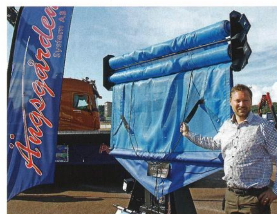
Hycover med fjärrstyrning för glidersläp integrerat i P-lightenheten kan underlätta vardagen rejält för krokbielschaufförer. Peter Selander, Ångsgården System, demonstrerade konceptet.
