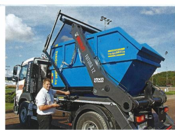
Thomas Himberg demonstrerade lättare (300-500 kg) Multilift Futura med lång räckvidd och fjärrstyrd täckning.
